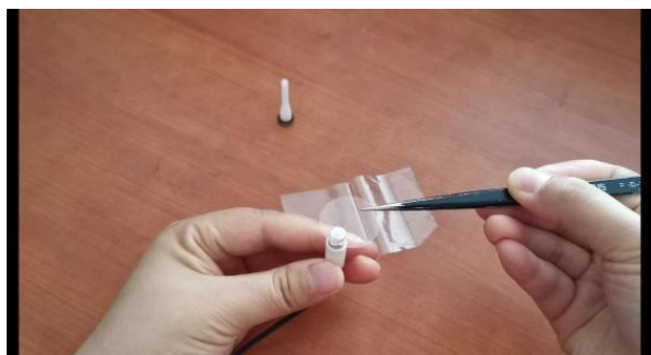
图 7 使用辅助器安装 O 形圈
