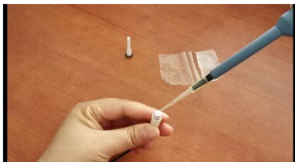
图 6 滴加电解液并覆盖透氧膜
