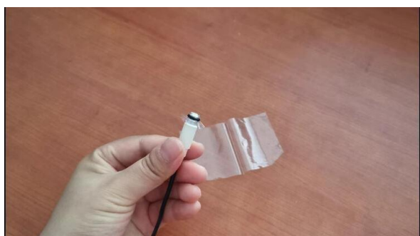
图 9 透氧膜安装完成
