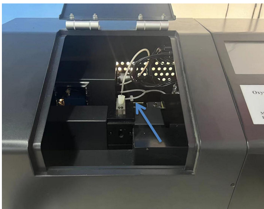
图 22 样品池区域及气路部件
